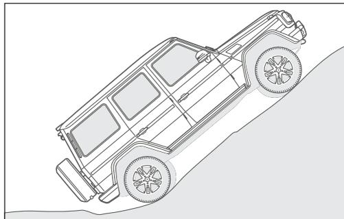
Steigfähigkeit bis zu 80 Prozent bei entsprechendem Untergrund.
