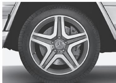
AMG Leichtmetallrad im 5-Speichen-Design mit Bereifung 275/50 R 20, titangrau lackiert und glanzgedreht (Serie für G 65 AMG, Code RM1).
