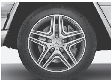
AMG Leichtmetallrad im 5-Doppelspeichen-Design mit Bereifung 275/50 R 20, titangrau lackiert und glanzgedreht (Serie für G 63 AMG, Code R10).
