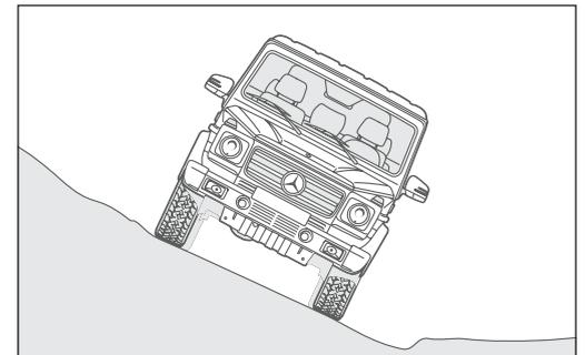
Fahrstabil noch bei Schräglagen von bis zu 54 Prozent.
