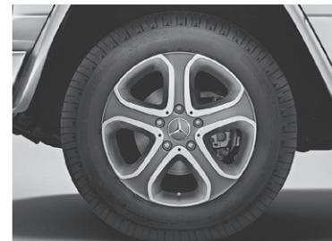
Leichtmetallrad im 5-Speichen-Design mit Bereifung 265/60 R 18, titangrau lackiert und glanzgedreht (optional für G 350 BlueTEC, G 500, Code RL5).
