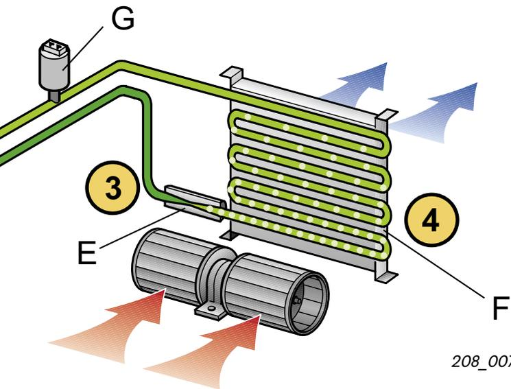
Впрыск жидкого хладагента в испаритель производится в отличие от контура с расширительным клапаном через дроссель.
