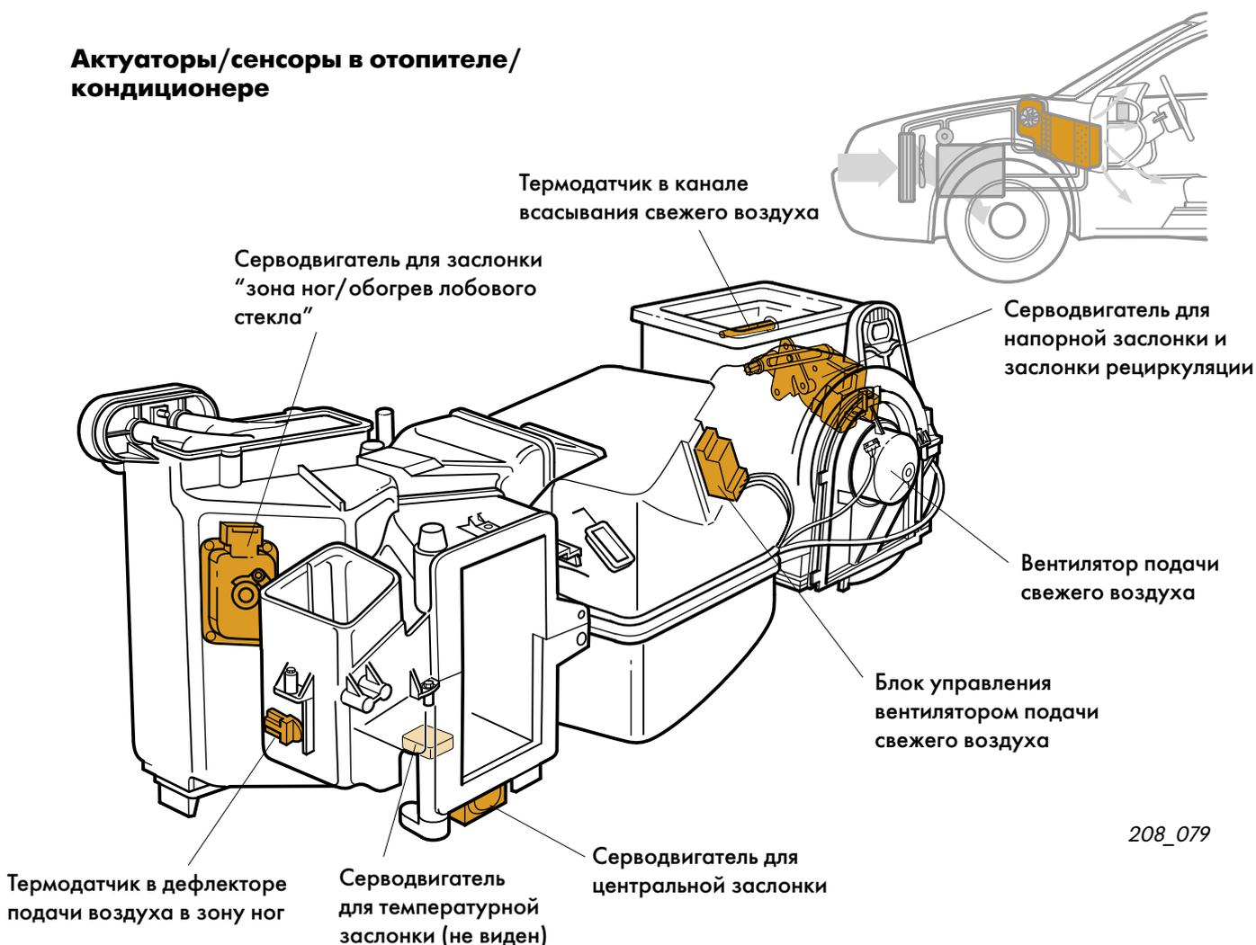
Каждая заслонка для распределение потоков воздуха в отопителе/кондиционере оборудована серводвигателем.
