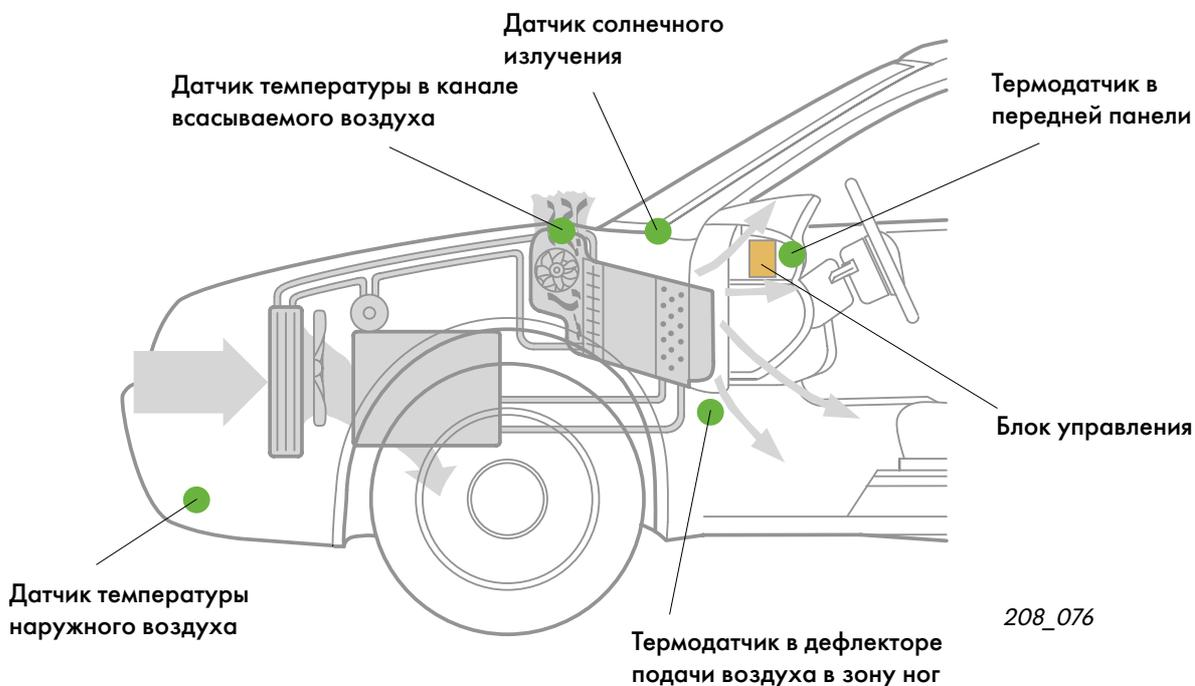
Климатические установки с автоматическим регулированием освобождают водителя от этих операций.
