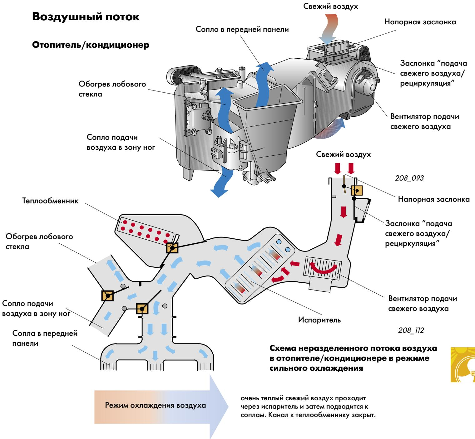
Направление потоков воздуха и распределение их всегда определяются конкретным исполнением отопителя/кондиционера и принятым уровнем комфортности.
