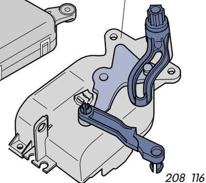
Серводвигатель для заслонки "подача свежего воздуха/ рециркуляция" и напорной заслонки
