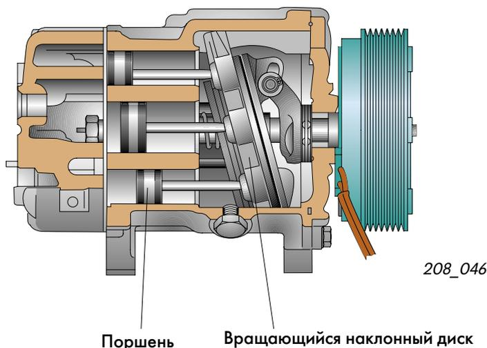
Саморегулирующийся компрессор с наклонным вращающимся диском.
