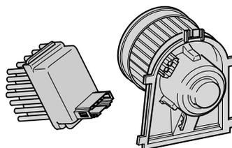
Блок управления вентилятором подачи свежего воздуха J126 и вентилятор подачи свежего воздуха V2
