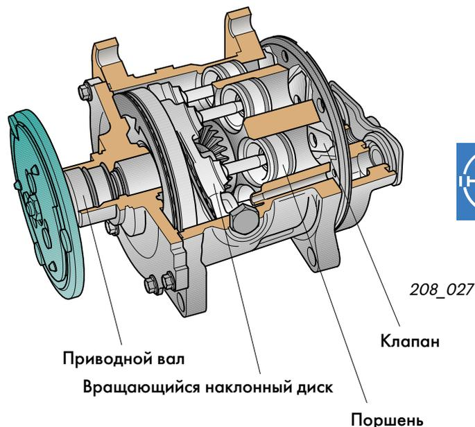
Несаморегулирующийся компрессор с наклонным вращающимся диском
