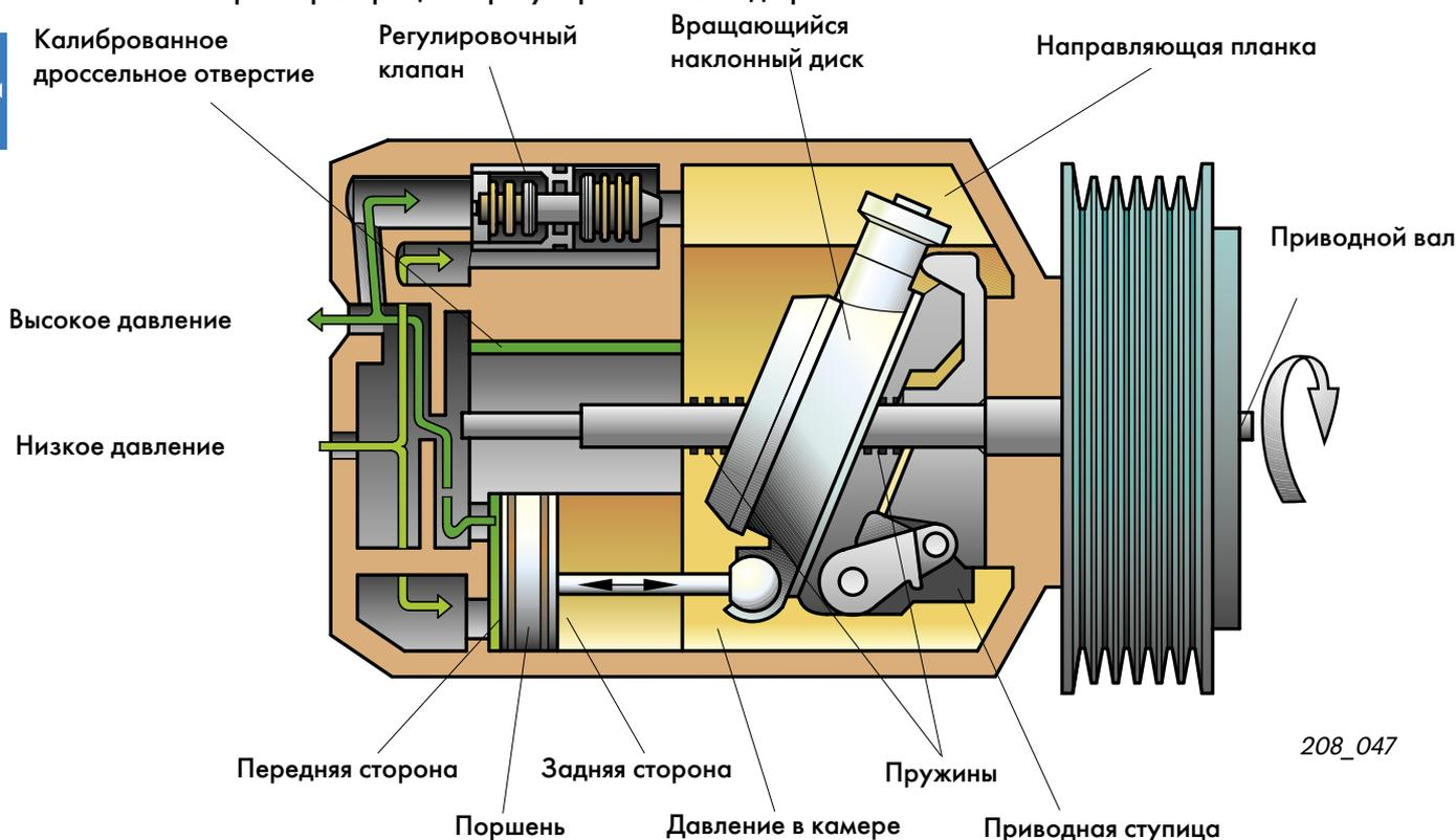
Вращательное движение приводного вала передается на приводную ступицу и посредством вращающегося наклонного диска преобразуется в возвратно-поступательное движение поршней.
