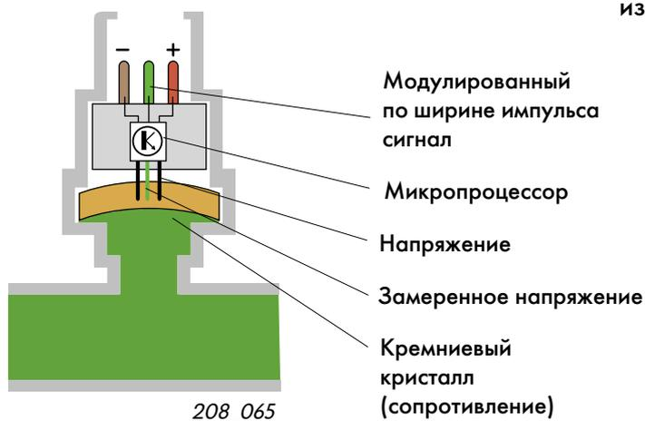
При высоком (возрастающем) давлении кристалл "деформируется" больше, вследствие чего больше изменение сопротивления. Замеряемое напряжение изменяется в такой же пропорции.
